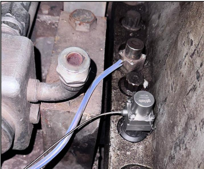
Установка датчиков виброскорости 2V222НН
