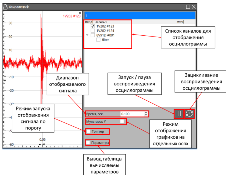
Рисунок 30. Элементы виртуального прибора «Осциллограф».
