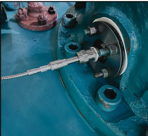
Установка радиальных вихрековых датчиков на нагнетатель ГПА
