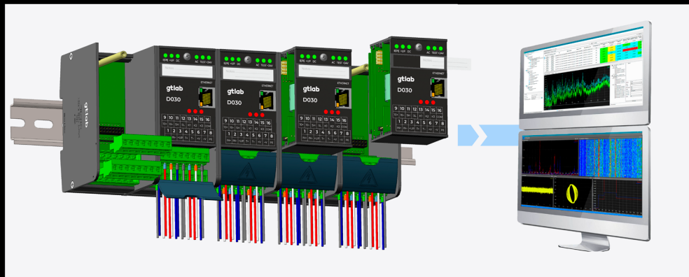
Модуль сбора данных (АЦП) D030
