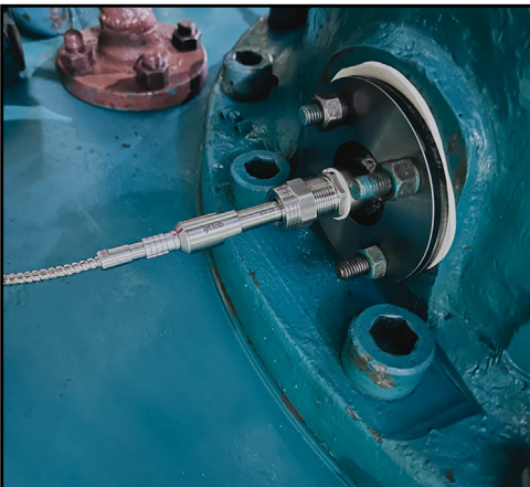
Установка радиальных вихрековых датчиков на нагнетатель ГПА
