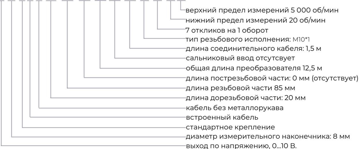
Состав вихретокового датчика.
