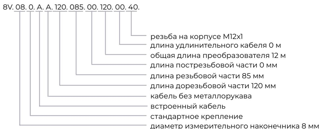
2. Формирователь сигналов. Маркировка (наносится предприятием-изготовителем на выбранный формирователь на основании конфигурации вихретокового датчика).
