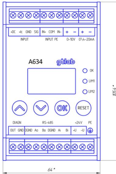
Рисунок 5 - Внешний вид, расположение органов управления и контроля А634
