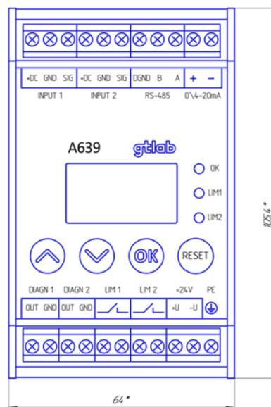
Рисунок 10 - Внешний вид, расположение органов управления и контроля А639
