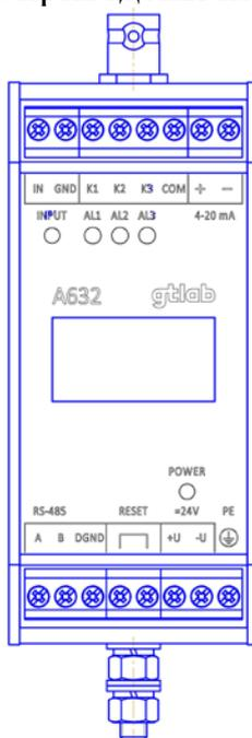
Рисунок 3 - Внешний вид, расположение органов управления и контроля А632
