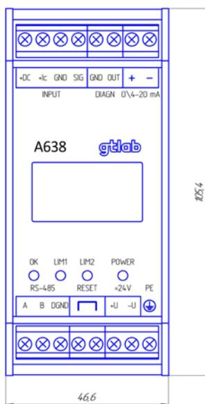
Рисунок 9 - Внешний вид, расположение органов управления и контроля А638
