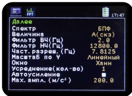
Рисунок 9. Режим «Спектроанализатор». Параметры измерения
