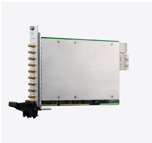
Модуль сбора данных D006 8 аналоговых каналов (24 бит, 128кГц)
